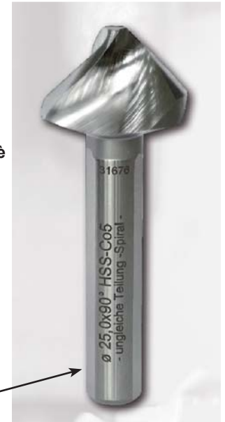
Zylinderschaft mit 3-Flächenanschliff 3-flats on shank to prevent slipping
