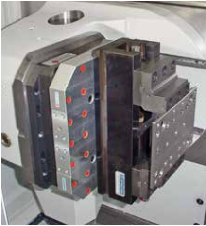
Mechanischer Zentrischspanner MZU 360-125 auf Palettiersystem Mechanical centre-clamping vise MZU 360-125 on a palletizing system
