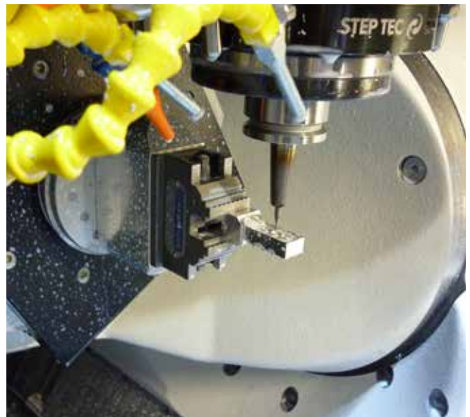
Mechanischer Zentrischspanner MZR 80-36 auf Palettiersystem Mechanical centre-clamping vise MZR 80-36 on a palletizing system
