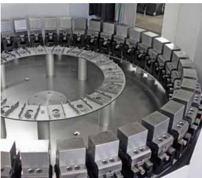
Einsatz auf automatischem Palettenwechsler SP-APC 1 Use on automatic pallet changer SP-APC 1
