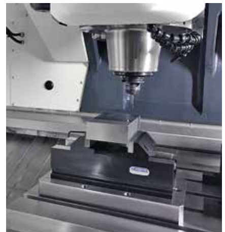
Mechanischer Zentrischspanner MZE 360-125 auf Unterbau Mechanical centre-clamping vise MZE 360-125 on base cube
