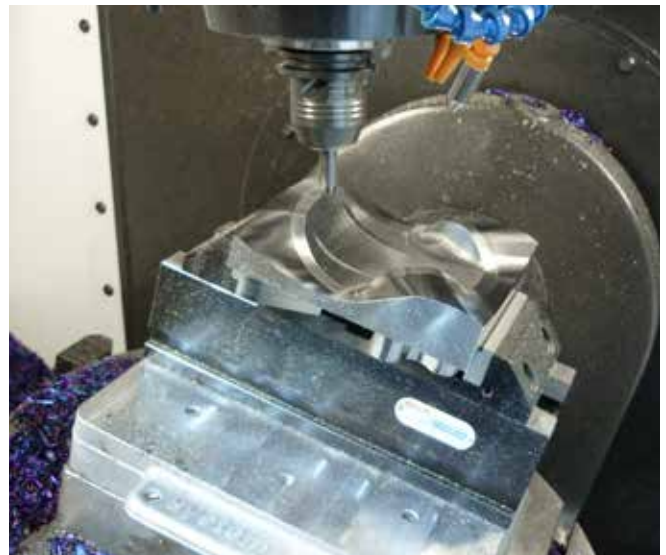
Mechanischer Zentrischspanner MZE 280-100 auf Palettiersystem Mechanical centre-clamping vise MZE 280-100 on a palletizing system
