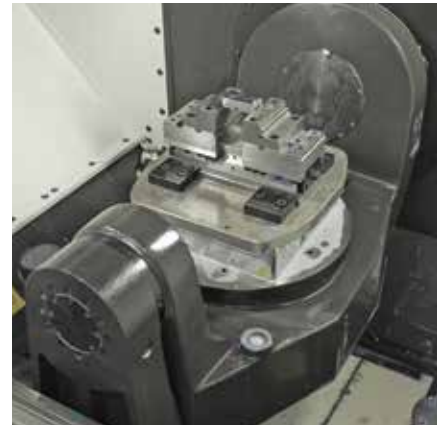
Mechanischer Zentrischspanner MZC 280-100 E auf Palettiersystem Mechanical centre-clamping vise MZC 280-100 E on a palletizing system
